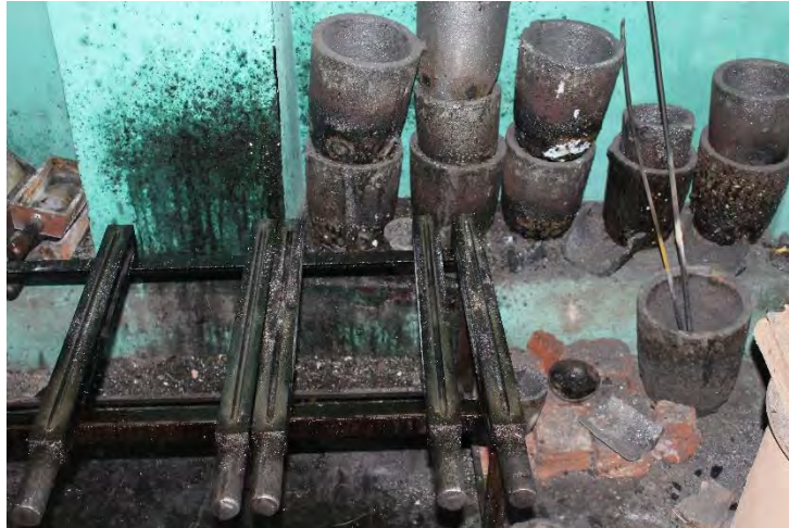
चित्र 1.2.15: चांदी को गर्म करने के लिए इस्तेमाल किए जाने वाले टेराकोटा के बर्तन
