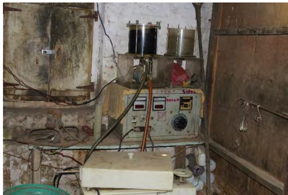
चित्र 1.6.5: पायल की अंतिम पॉलिशिंग के लिए इलेक्ट्रोप्लेटिंग वाइब्रेटर
