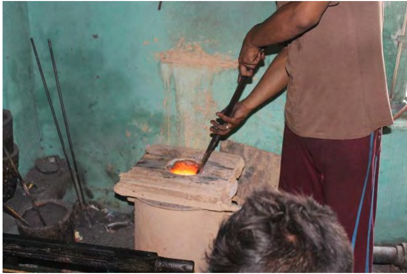
चित्र 1.3.4: पिघली हुई चांदी के साथ टेराकोटा के बर्तन को भट्टी से सावधानी से निकाला जाता है
