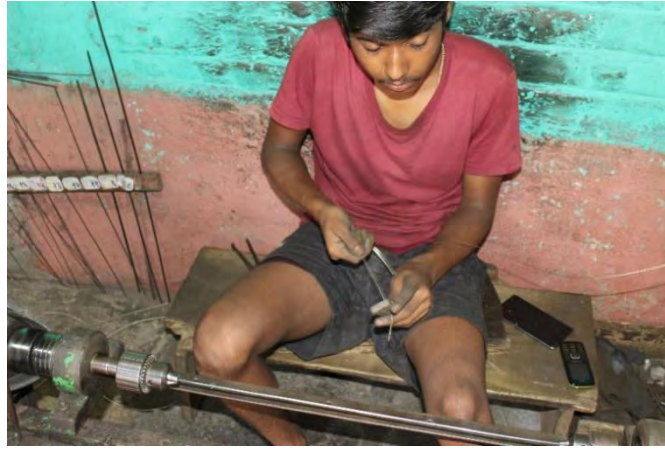
चित्र 1.3.9: चाँदी के तार खींचने के लिए गेज प्लेट का प्रयोग करना
