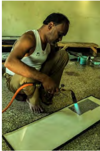
चित्र 1.5.3: फ्लेम टॉर्च का उपयोग करके पायल के घटकों की सोल्डरिंग
