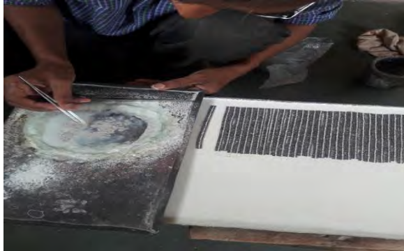
चित्र 1.2.13: सोल्डरिंग सामग्री (फ्लक्स): इसका उपयोग विभिन्न पायल घटकों को जोड़ने के लिए किया जाता है।
