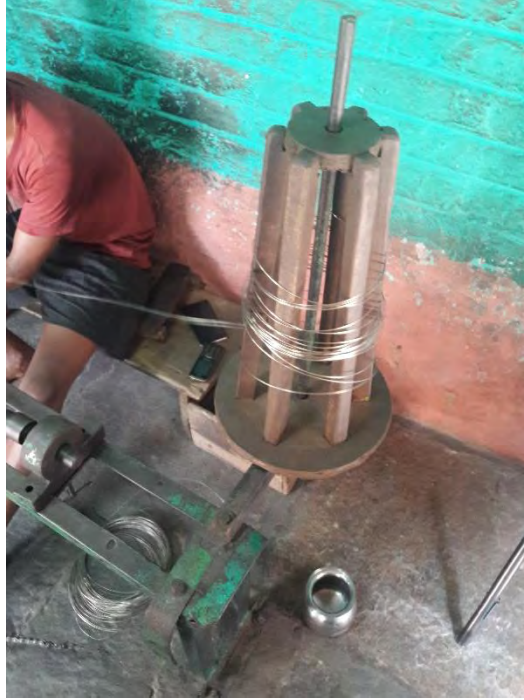
चित्र 1.3.8: चाँदी की छड़ों को तारों में बदलने के लिए रोलिंग मशीन
