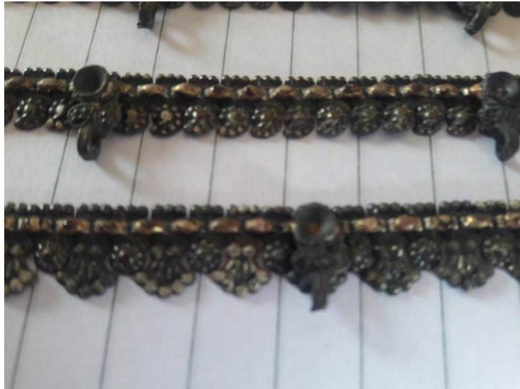
चित्र 1.6.1: जाली प्रक्रिया के बाद चांदी की पायल काली हो जाती है।
