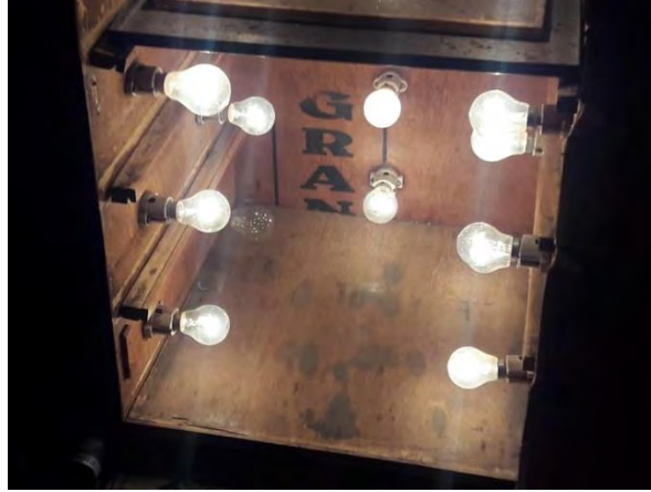
चित्र 1.6.4: पायल के मीना रंग को सुखाने के लिए बिजली के बल्ब की भट्टी
